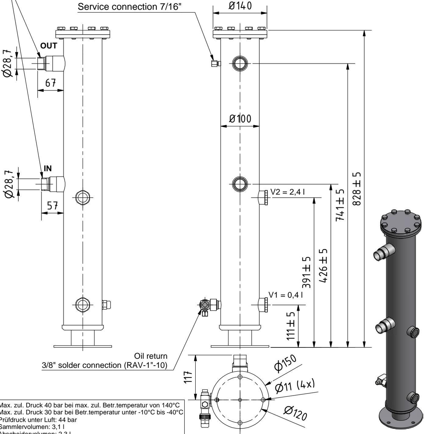
Max. zul. Druck 40 bar bei max. zul. Betr.temperatur von 140°C
