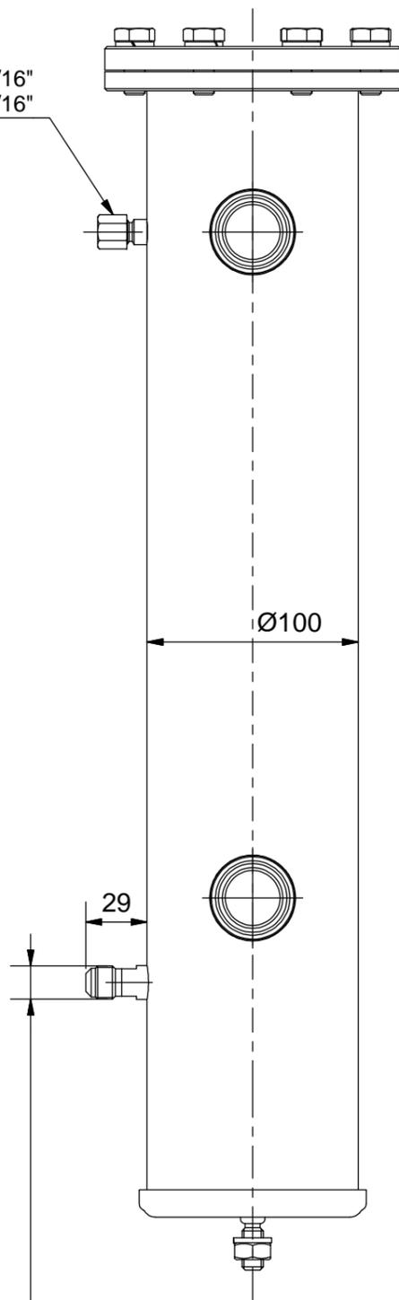
Ölrückführung 10x1 Bördel (Gewinde: 5/8"-18 UNF)
