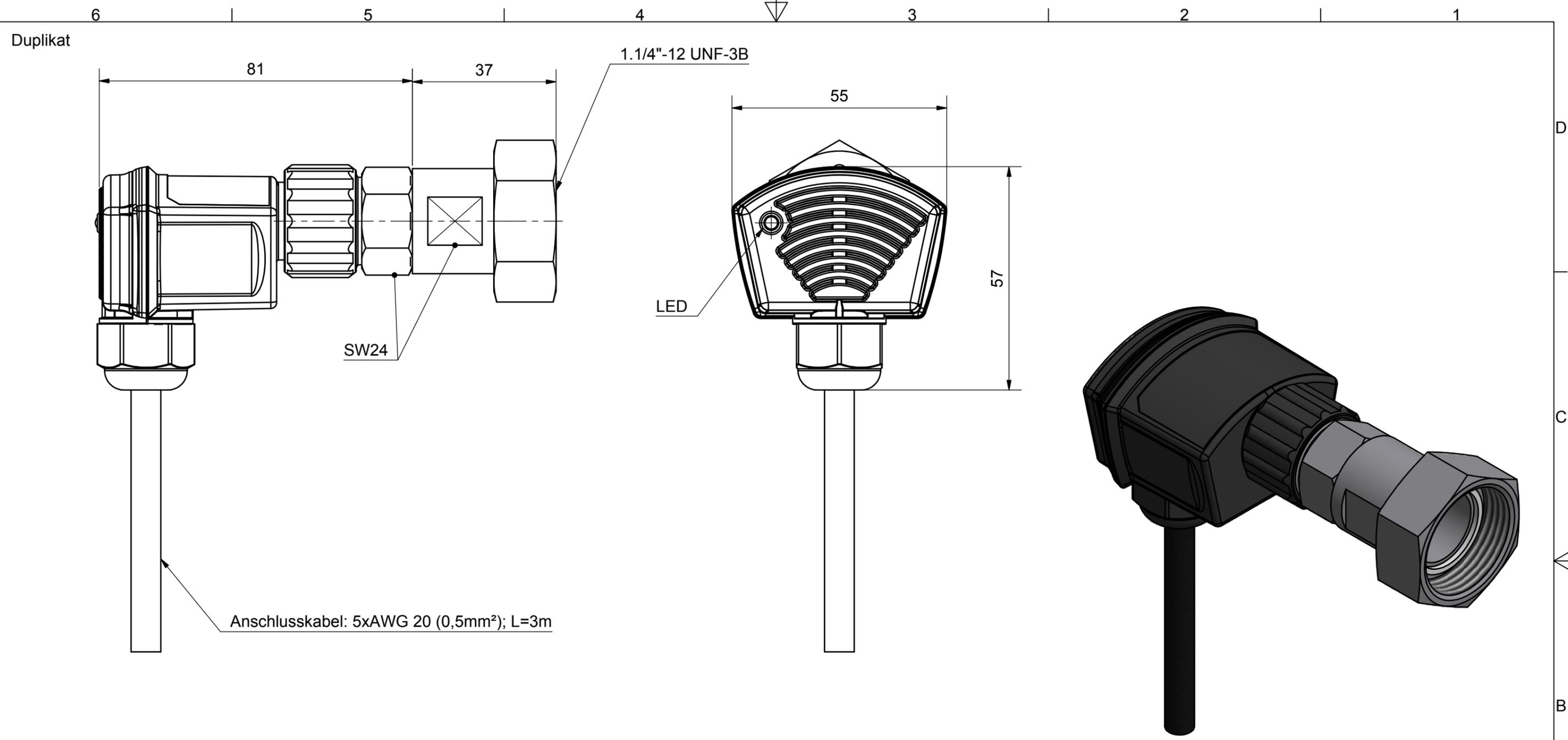
Anschlusskabel: 5xAWG 20 (0,5mm<sup>2</sup>); L=3m
